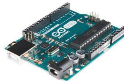
Fig. 4 Arduino UNO R3
